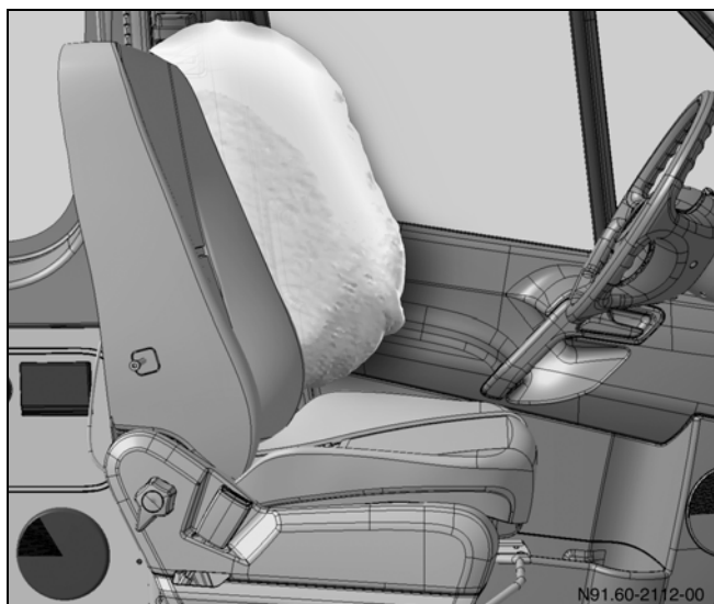
Obszar otwierania poduszki chroniącej klatkę piersiową z lewej strony pojazdu
